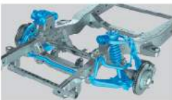
HỆ THỐNG TREO TRƯỚC TAY ĐÔI KÉP: Giúp cải thiện khả năng vào cua và tăng độ vững chắc khi vận hành.
