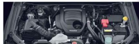
ĐỘNG CƠ R24E-TC 1.9L: Công suất lớn nhất 150 Ps tại vòng tua 3,600 rpm / sức kéo lớn nhất 350 Nm tại vòng tua 1,800 - 2,600 rpm.
