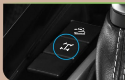
Khóa vi sai cầu sau cho phép phân bổ lực kéo đều cho hai bánh xe sau, giúp xe dễ dàng vượt qua địa hình phức tạp.
