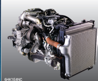
Bộ Turbo biến thiên tăng áp VGS / Variable Geometry System Turbo
